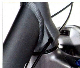
Hohe Sorgfalt beim Verschweißen und elegante Kabelführung zeigt das Veneto im Detail.
