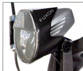
Ein wenig wacklig wirkt das Plastikgehäuse am LED-Scheinwerfer der ZEG-Zubehörmarke.
