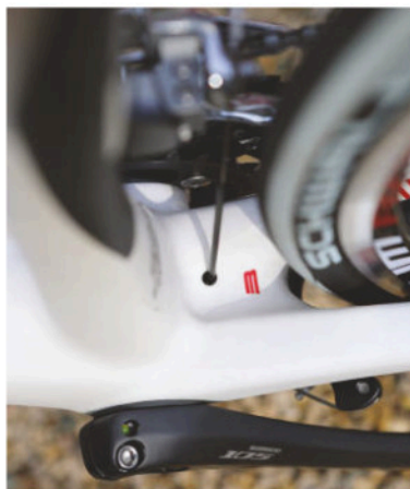
Zichtbaar gebogen staande buis.
