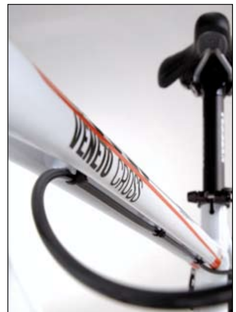
Typisch KTM: Die Kabel sind optisch sauber unter den Rohren versenkt.
