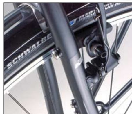
Aufnahmen für Rahmenschloss, Seitenläufer erweitern den Nutzen.
