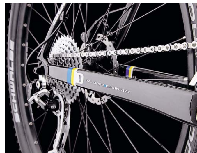
Angepasst: Mit der Rahmenhöhe wächst die Kettenstange.
