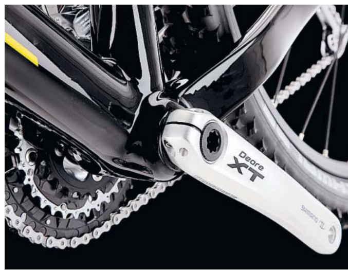
Tiefgelegt: Die Tretlager-Position verbessert die Schwerpunktlage.
