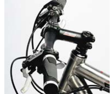
2_Geader Lenker: Der flache Lenker und ein niedriges Steuerrohr sparen Bauhöhe – gut bei 29ern.
