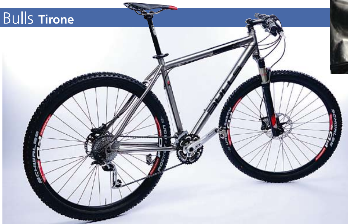
2_Geader Lenker: Der flache Lenker und ein niedriges Steuerrohr sparen Bauhöhe – gut bei 29ern.
