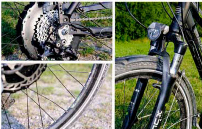
Oben: Der Hinterradmotor schiebt gut an, regelt aber etwas abrupt ab. Unten: Die Hinterradspeichen lockern sich schnell – das sollte verbessert werden. Rechts: Die Federgabel entfaltet besonders auf Schotter- und Waldwegen ihre Wirkung.
