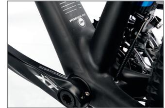
Der großvolumige Tretlagerbereich generiert extreme Steifigkeit.
