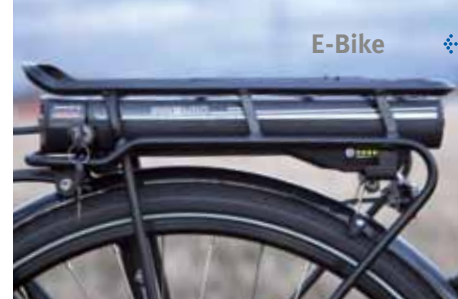
Neues Energiepaket: Der 400 Wh-Akku im Träger erhöht die Reichweite gegenüber dem alten 288 Wh-Modell und ist leicht zu entnehmen.
