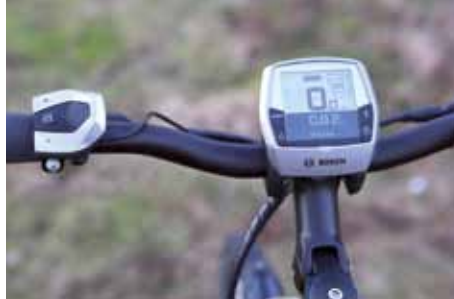
Gut lesbar und leicht zu handhaben: Das neue Bosch Intuvia-Display sitzt über dem Vorbau, sein Bedienelement liegt in Griffweite.
