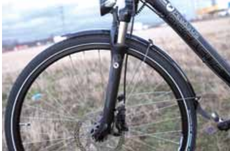
Sicher und komfortabel: die Suntour NEX-Feder- gabel mit guter Stoßdämpfung und Schwalbe Marathon Plus Reifen mit Top-Pannenschutz.
