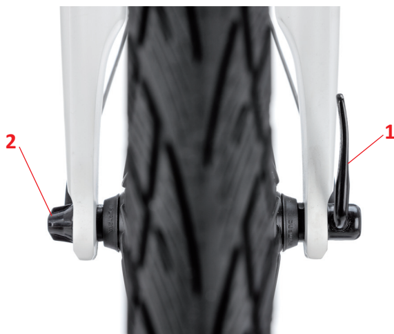
Abbildung 11: Vorschriftenmäßige Montage des Schnellspanners am Vorderrad
