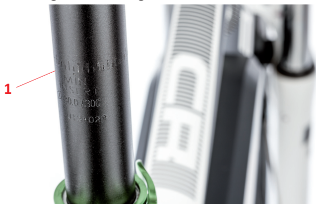
Abbildung 9: Markierungen zur Mindesteinstecktiefe der Sattelstütze
