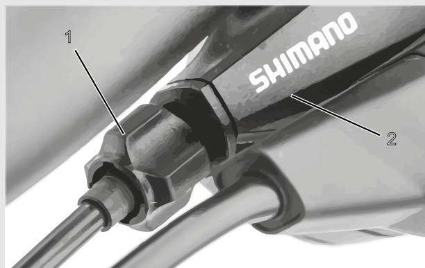
Figura 96: Boccola di regolazione (1) del cambio azionato da cavo singolo con scatola della leva del cambio (2), esempio
