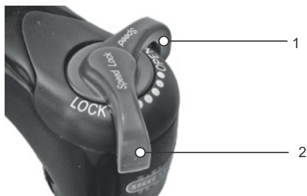
Figura 91: Ammortizzatore a stadi di pressione Suntour in posizione aperta (1) e chiusa (2)
