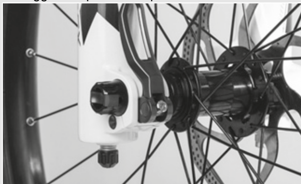
Figura 94: Regolazione della forza di serraggio del bloccaggio rapido
