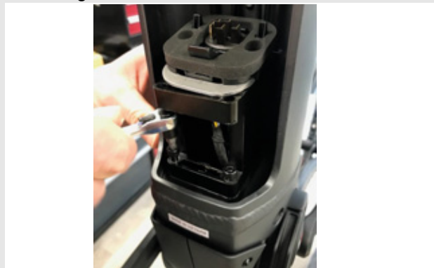
Figura 35: Rimozione delle viti a testa esagonale da 4 mm
