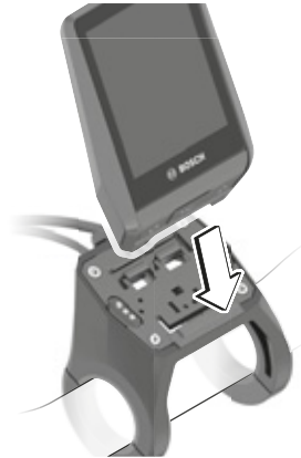
Figura 66: Applicazione del computer di bordo
