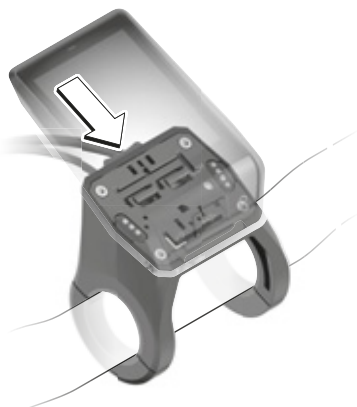
Figura 68: Pressione sul meccanismo di sblocco
