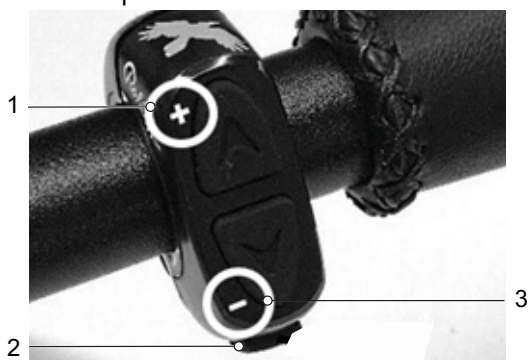
Figura 92: Pulsante sul manubrio della Rohloff E-14
