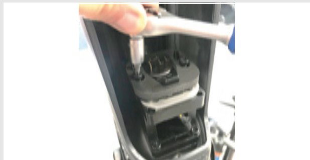
Figura 34: Svitamento delle viti del portabatteria
