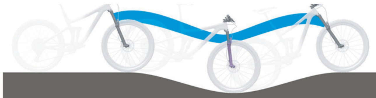
Figura 89: Comportamento di marcia ottimale su un terreno con dossi
