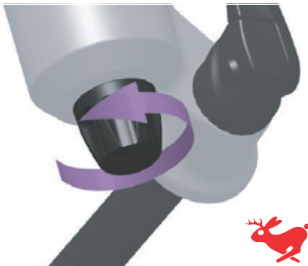
Figura 102: Rotazione dell'ammortizzatore a stadi di trazione in direzione lepre
