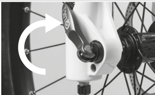
Figura 46: Chiusura del bloccaggio rapido
