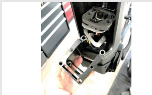
Figura 37: Estrazione dell'adattatore PowerTube
