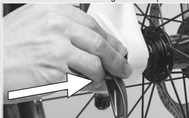
Figura 44: Inserimento del bloccaggio rapido
