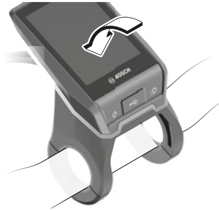
Figura 67: Spinta del computer di bordo in avanti
