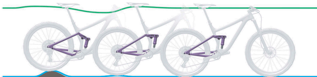
Slika 142: Prebrzo odskakivanje stražnjeg amortizera
