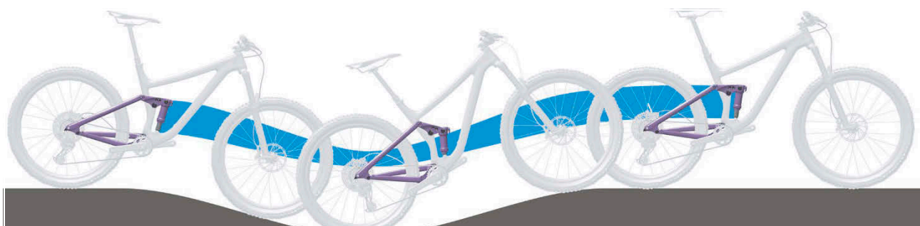
Slika 146: Premekan ovjes stražnjeg amortizera na uzbrdici
