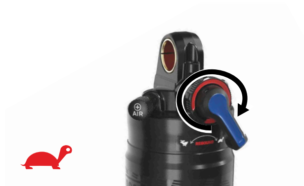
Slika 95: Smanjenje brzine odskoka
