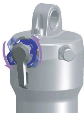
Slika 149: Smanjenje krutosti kotačićem za podešavanje kompresije
