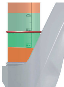
Slika 85: Propisano područje SAG-a (zeleno) i zabranjeno područje SAG-a (crveno)
