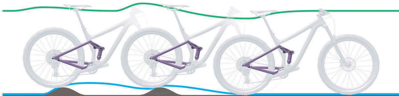
Slika 144: Presporo odskakivanje stražnjeg amortizera
