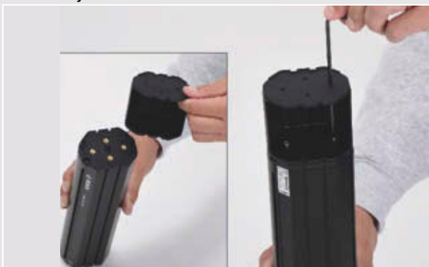
Slika 45: Montaža PowerTube produžetka
