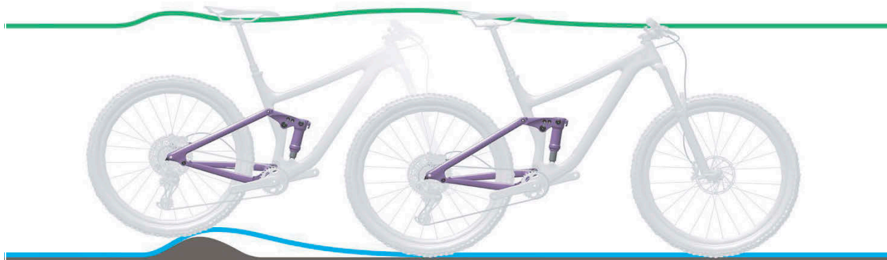
Slika 148: Prekruta amortizacija stražnjeg amortizera na neravninama
