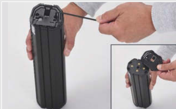
Slika 41: Demontaža gornjeg sučelja
