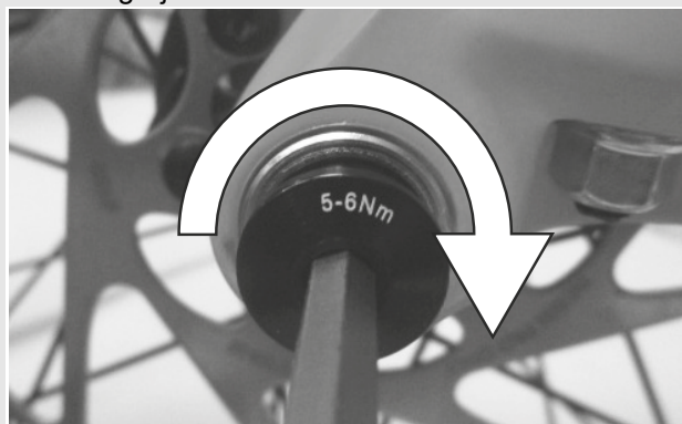
Slika 51: Pritezanje sigurnosnog vijka
