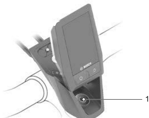
Slika 111: Položaj vijka za ležaj upravljača
