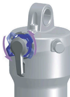
Slika 101: Smanjenje krutosti kotačićem za podešavanje kompresije
