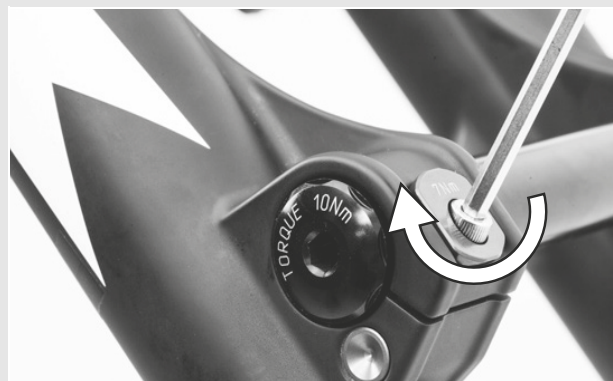
Slika 53: Pritezanje sigurnosnog vijka
