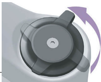
Slika 124: Smanjenje krutosti kotačićem za podešavanje kompresije
