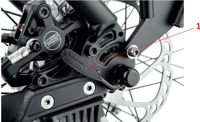
Abbildung 14: Vorschriftsmäßige Montage des Schnellspanners am Hinterrad
