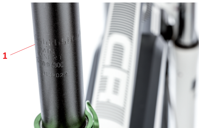
Abbildung 9: Markierungen zur Mindesteinstecktiefe der Sattelstütze (Beispiele)
