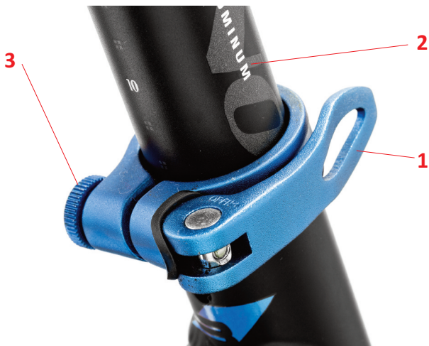
Abbildung 15: Schnellspanner der Sattelstütze (Beispiel)
